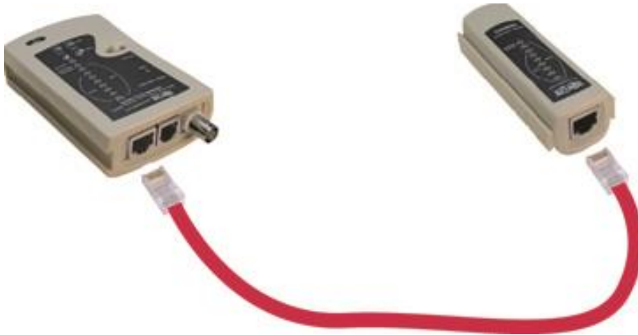
شكل رقم ٧١: طريقة توصيل جهاز فحص الشبكة
