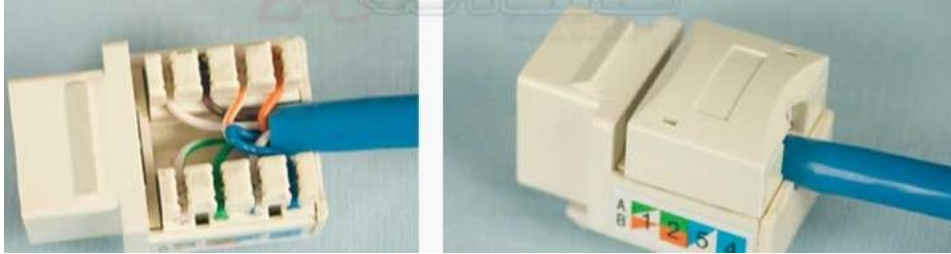
شكل رقم ١٤٤: تركيب الغطاء الخارجي لمقبس RJ45
