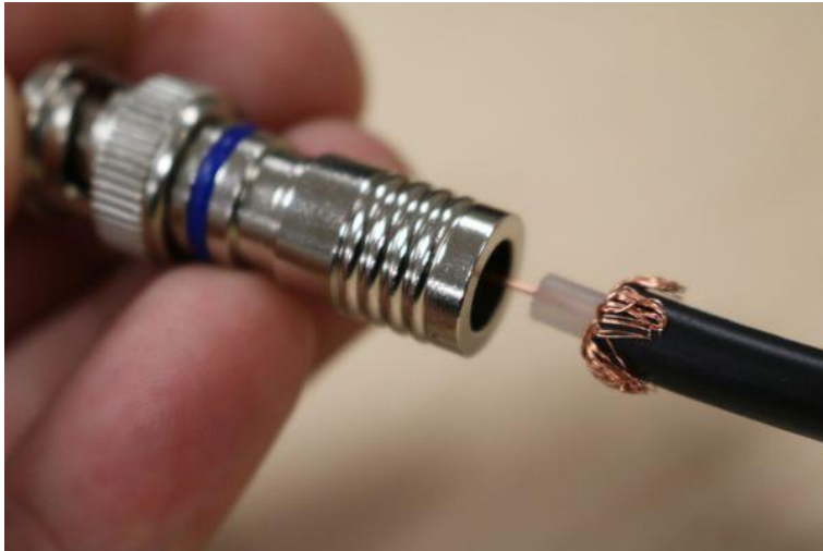
شكل رقم ١٠١: إدخال الكابل المحوري في وصلة BNC
