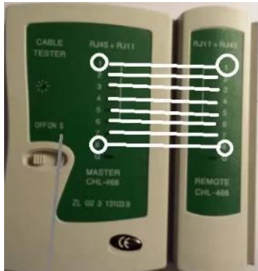
شكل رقم ٧٣: عملية إختبار كابل من نوع التقابل المباشر (Straight Through)
