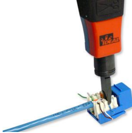
شكل رقم ١٤٢: عملية تدبيس السلك في المكان المخصص
