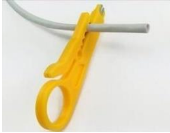
شكل رقم ١٢٩: إستخدام القشارة لتعريية سلك (UTP)
