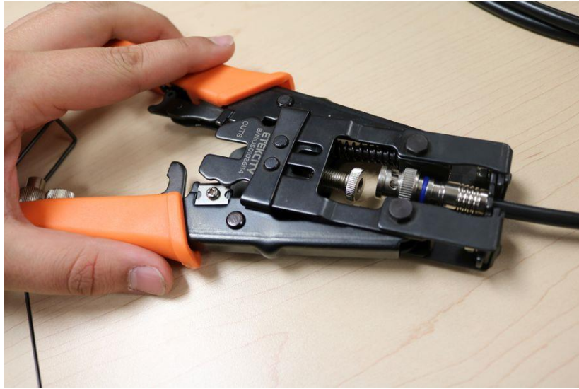
شكل رقم ١٠٢: أداة الكبس والشكل النهائي لكابل الشبكة المحوري بعد عملية الكبس في وصلة BNC
