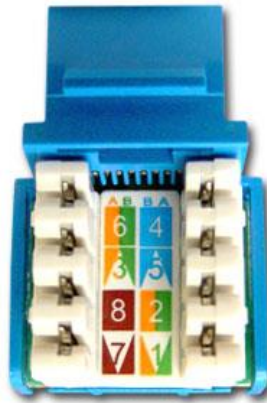
شكل رقم ١٠٨: ترتيب الألوان حسب الترتيب القياسي (EIA/TIA A, B) صورة أفقية لمقبس RJ45
