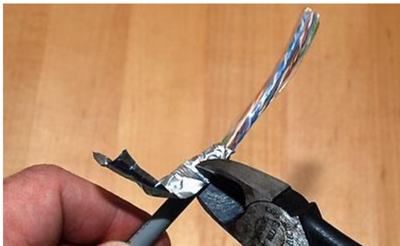
شكل رقم ١١٩: قص الزائد من الغلاف المعدني (Shield) الداخلي
