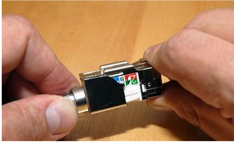
شكل رقم ١٢٦: تركيب الغطاء الخارجي لمقبس RJ45 Cat6
