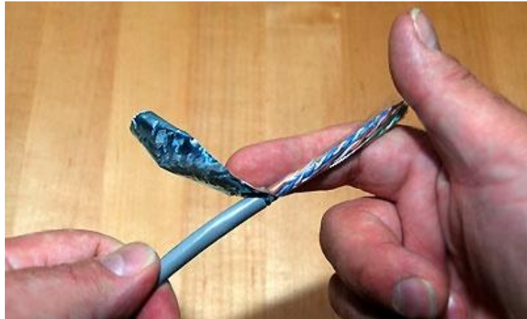
شكل رقم ٩٥: ثني الغلاف المعدني (Shield) الداخلي
